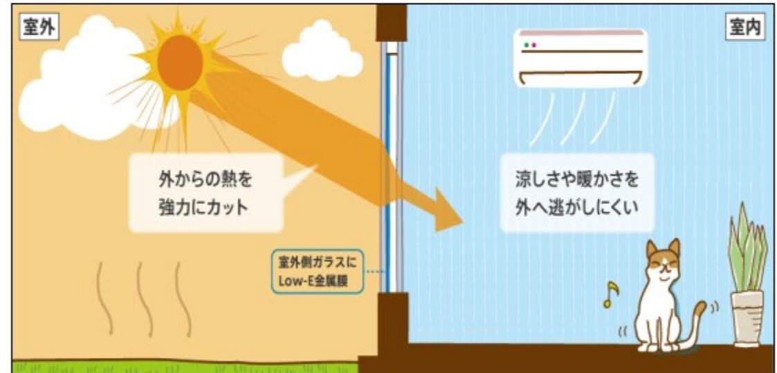
複層ガラスの室内側ガラスをLow-E金属膜でコーティング。遮熱性にも断熱性にも優れています。断熱はもちろんのこと、明るさを取りながらもガラスに当たる日射熱を遮り、室内を涼しく保つタイプです。
