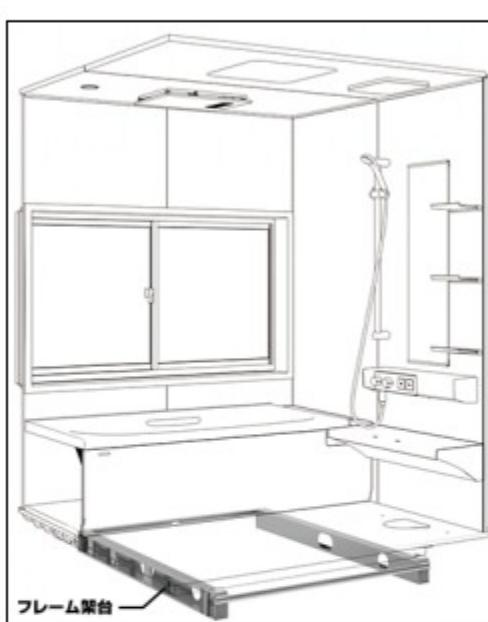
耐震システムバスの呼び名を付けたタカラの浴室は、頑丈なフレーム構造の架台が浴室全体をしっかりと支え、震度6強相当の振動にも耐える（過酷な三次元耐震実験で実証）強い浴室です。
